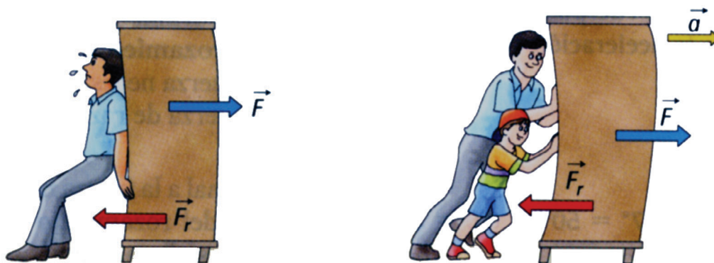
Cuando un objeto se encuentra en reposo actúa la fuerza de rozamiento estático.
