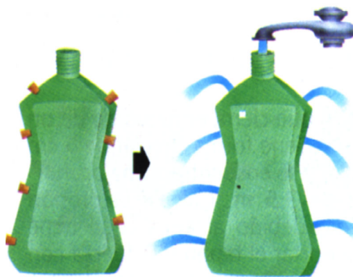
Las fuerzas producidas por un líquido son perpendiculares a las paredes del recipiente
