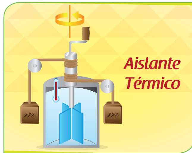
Figura 3. El experimento que Joule utilizó para determinar el equivalente mecánico del calor.
