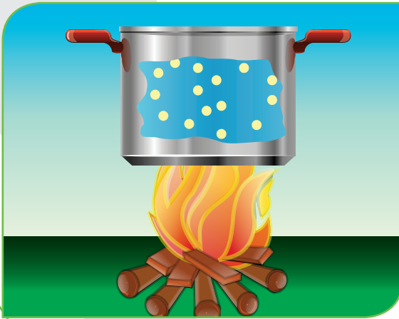
Figura3. Transferencia de calor por convección.
